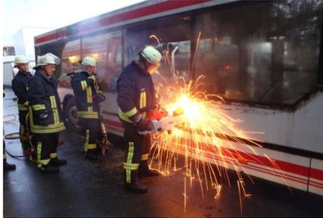
Außenhaut des Busses aufgeschnitten um in die Fahrgastzelle zu gelangen. Auch wurde der Bus von oben bestiegen und im Inneren mittels Schere und Spreitzer Sitzreihen gelöst um fiktiv eingeklemmte Personen zu befreien.
